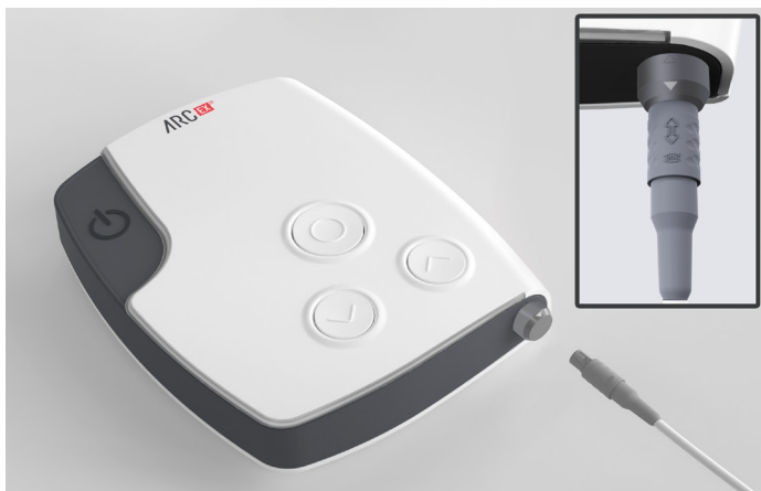
Figura 19. Conexión de la caja distribuidora al estimulador
