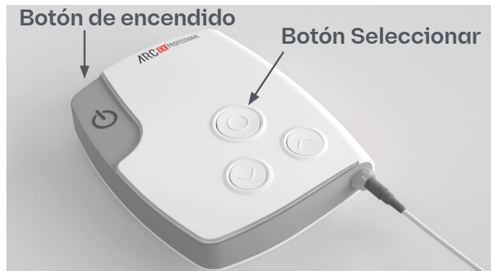
Figura 24. Interrupción inmediata de la estimulación con los botones de Encendido o Seleccionar.
