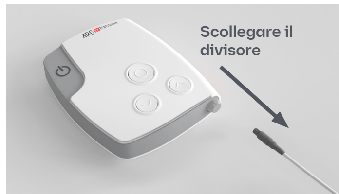
Figura 25. Interruzione rapida della stimolazione scollegando il divisore.
