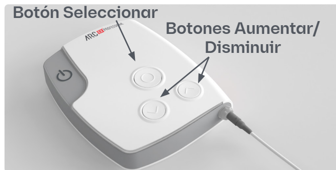
Figura 23. Control de la estimulación desde el estimulador ARC EX
