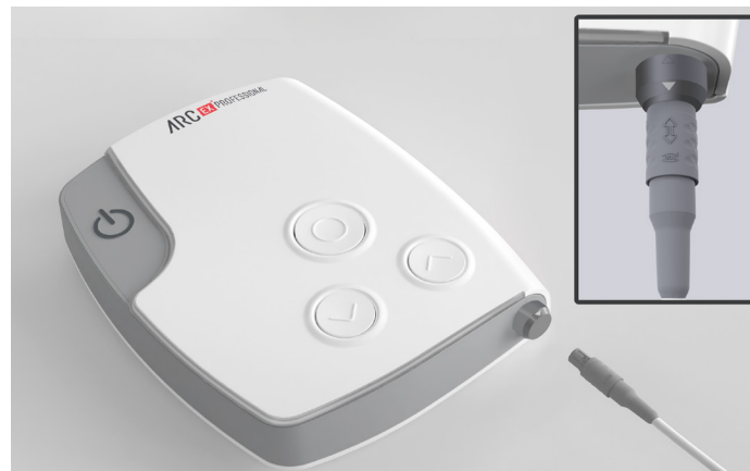
Figura 19: Conexión del distribuidor central al estimulador
