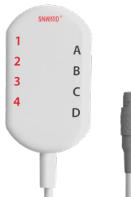
El distribuidor central se utiliza para conectar el estimulador a los electrodos (a través de los cables de extensión).
