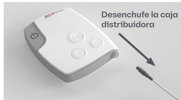
Figura 25. Interrupción inmediata de la estimulación desenchufando la caja distribuidora.
