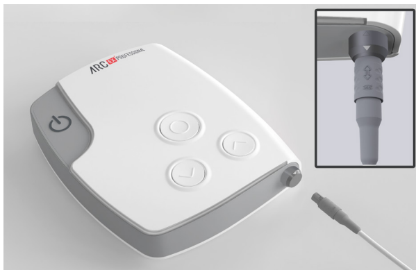
Figura 19. Conexión de la caja distribuidora al estimulador
