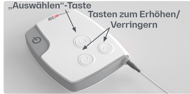
Abbildung 23. Steuerung der Stimulation vom ARC EX Stimulator
