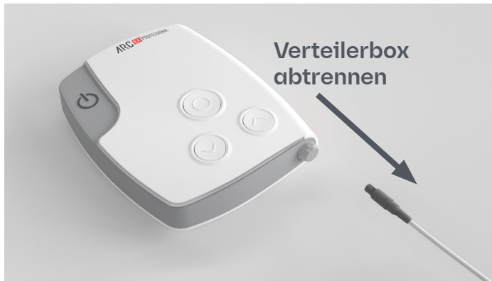
Abbildung 25. Sofortige Unterbrechung der Stimulation durch Abziehen der Verteilerbox,
