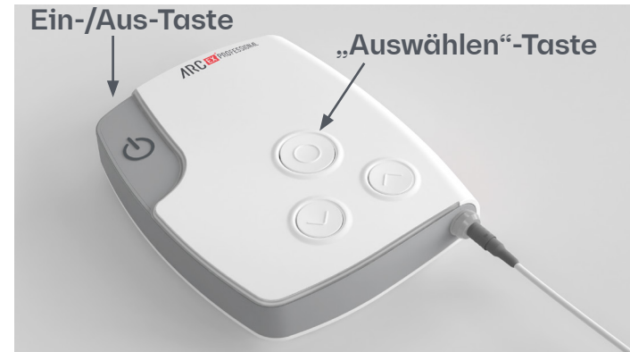
Abbildung 24. Sofortige Unterbrechung der Stimulation mit Ein-/Aus-Taste oder „Auswählen“-Taste.
