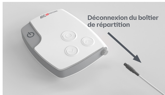
Figure 25. Interruption rapide de la stimulation en débranchant le boîtier de répartition.
