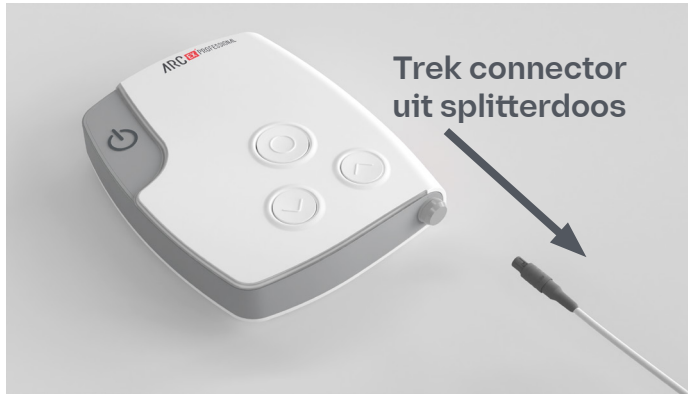
Afbeelding 25. Onmiddellijk afbreken van de stimulatie door de splitterdoos los te koppelen
