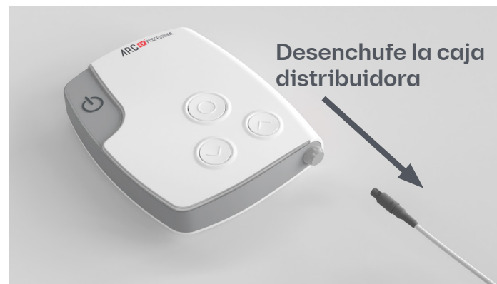
Figura 25. Interrupción inmediata de la estimulación desenchufando la caja distribuidora.
