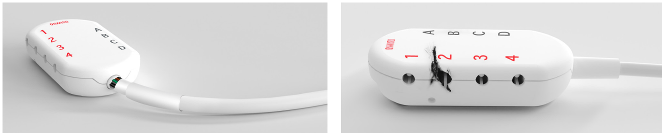
Abbildung 1. Beispiele für eine beschädigte Splitterbox. Die aufgeführten Beispiele sind nicht vollständig, sie dienen lediglich zur Veranschaulichung.
