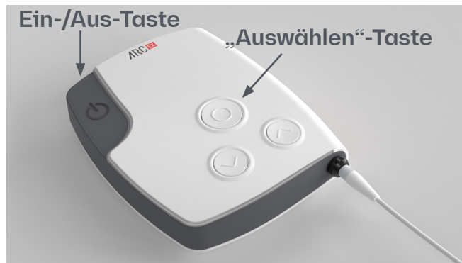
Abbildung 23. Sofortige Unterbrechung der Stimulation mit „Ein-/Aus“-Taste oder „Auswählen“-Taste.
