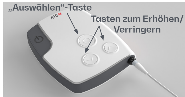
Abbildung 22. Steuerung der Stimulation ohne Programmiergerät
