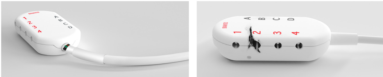
Figure 1. Exemples de boîtier de répartition endommagé. Ces exemples ne sont pas exhaustifs.
