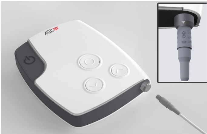
Figura 19. Collegamento del divisore allo stimolatore
