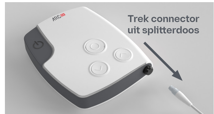
Afbeelding 24. Onmiddellijk afbreken door de splitterdoos los te koppelen.
