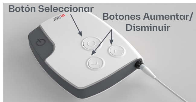
Figura 22. Control de la estimulación sin el programador
