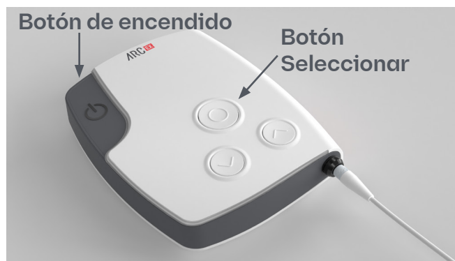
Figura 23. Interrupción inmediata de la estimulación con los botones de «Encendido» o «Seleccionar»
