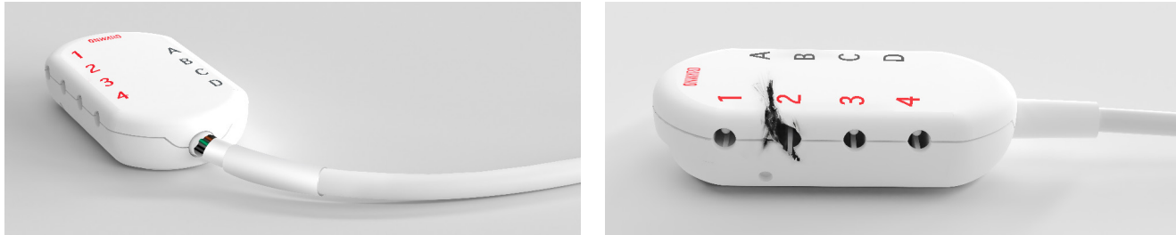
Figura 1. Ejemplos de una caja distribuidora dañada. Estos ejemplos no son exhaustivos.
