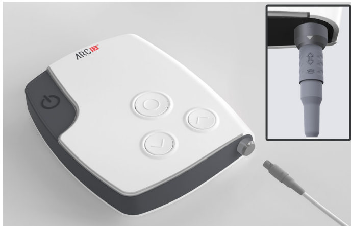
Figura 19. Conexión de la caja distribuidora al estimulador
