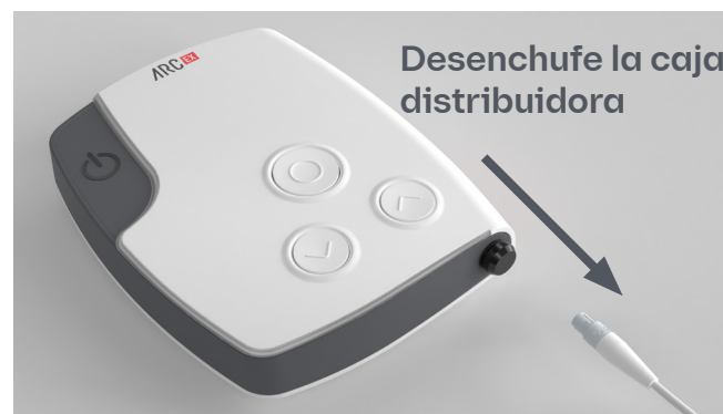
Figura 24. Interrupción inmediata desenchufando la caja distribuidora.
