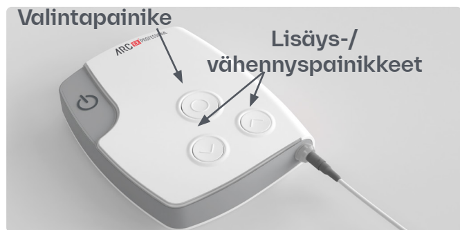
Kuva 23. Stimulaation hallinta ARC EX -stimulaattorista
