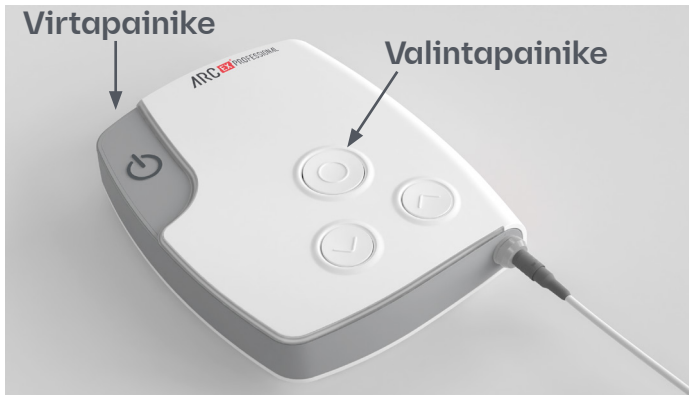
Kuva 24. Stimulaation nopea keskeyttäminen virta- tai valintapainikkeella
