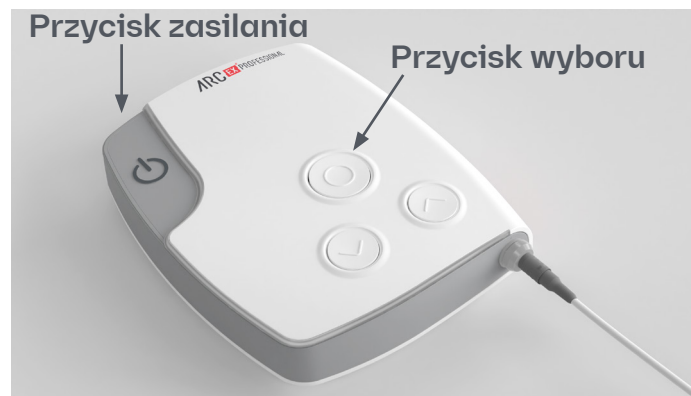
Rysunek 24. Natychmiastowe przerwanie stymulacji za pomocą przycisku zasilania lub przycisku wyboru.
