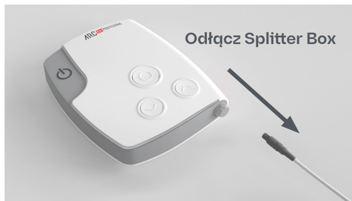
Rysunek 25. Natychmiastowe przerwanie stymulacji poprzez odłączenie Splitter Box.
