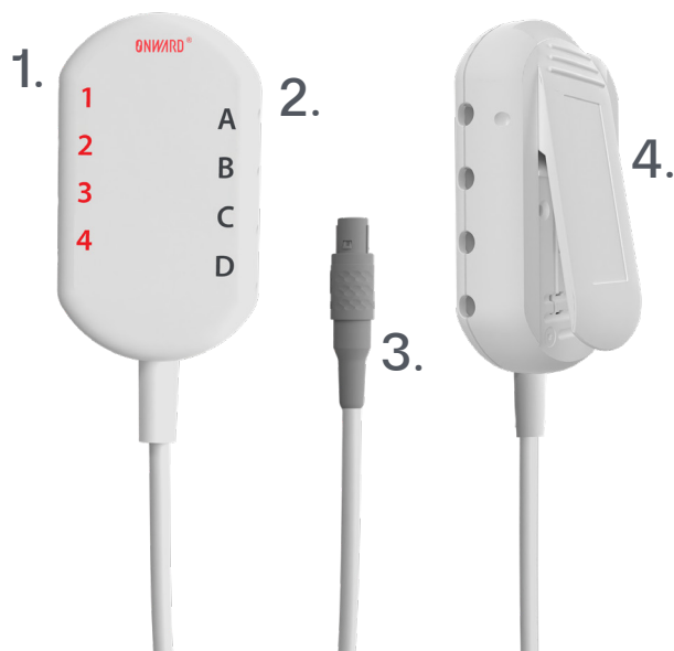
Figura 3. Caixa divisora ARC EX
