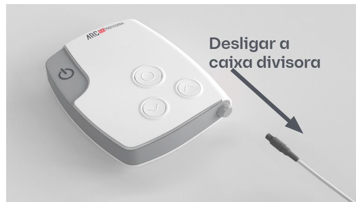
Figura 25. Interrupção imediata da estimulação desligando a caixa divisora.
