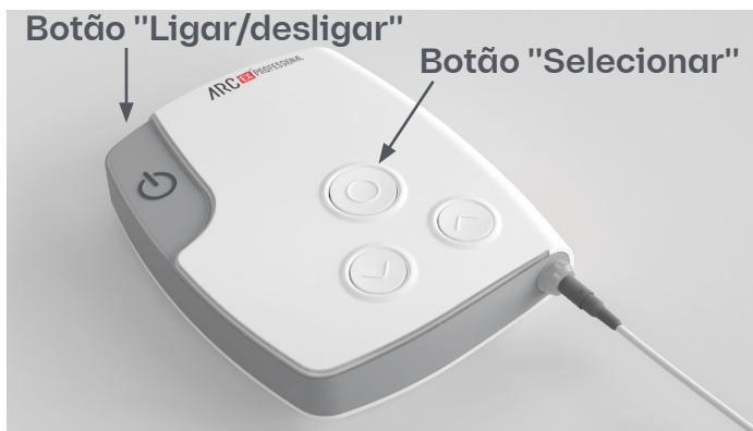
Figura 24. Interrupção imediata da estimulação com os botões "Ligar/desligar" ou "Selecionar".
